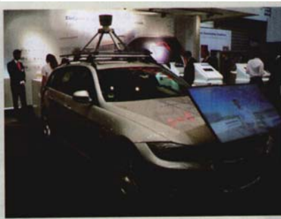
図34 ボッシュ社の自動運転 屋根の上に回転型のレーザーレーダーミリ波レーダー、ステレオカメラ、レーザーレーダの情報を得てコントロールする。
