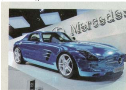
図4 Daimler EV SLS AMG ED 航続距離 250Km, 電池質量 548kg
