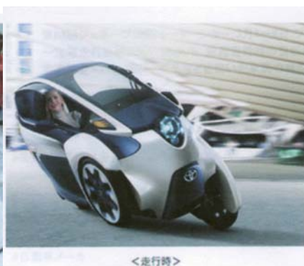
図 17 トヨタ I-ROAD 超小型モビリティのコンセプトカー 前輪のインホイールモータを搭載（詳細上述）
