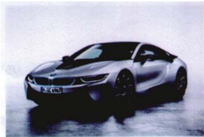
図36 BMW PHEV スポーツクーペ 1.5リッター3気筒エンジン（231hp）と131hpのモータの組み合わせ。燃費等は上述
