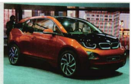
図38 BMW 「i3」 2014年から販売 3万9450ユーロ（130万円換算 454万円）アルミシャシー、アッパーボディがCFRP,1195Kg航続距離190Km、レンジエクステンデッドEVも同じ車体
