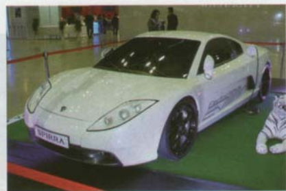
図 21 Oullim Networks 社 EV Spirra EV 航続距離；200Km、CFRP 車体のスポーツカー、後輪 2 モーター
