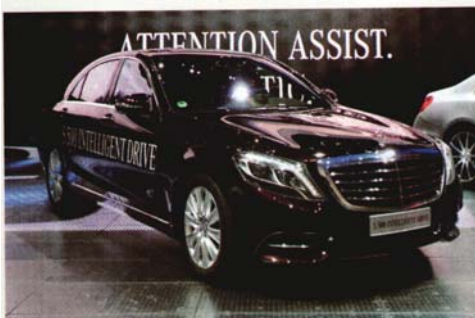
図33 ダイムラー社の自動運転車 車両の前後左右に60m先、200m先の障害物を検知できるレーダー（中遠距離）と車輪4隅に近距離レーダーを、前方にステレオカメラ後方に単眼カメラを装備
