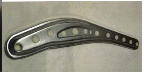
図 32 大成プラスと三井化学 Al 板金 2 枚の最中の中に発泡 PP 両社で共同開発、シート部材として 開発。強度、剛性アップ、質量 1/3
