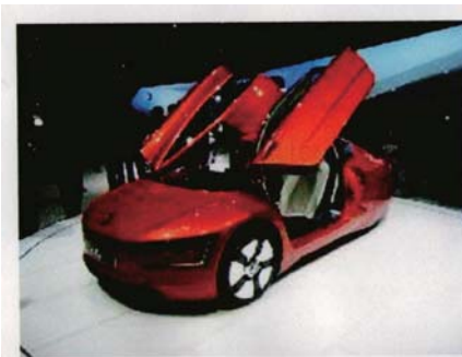
図 13 VW XL1 PHEV 燃費 ; 111Km/L、0.8L2 気筒 直噴ターボディーゼル 7 速 DCT、CFRP 車体基本骨格、車輻重量 795Kg、2 人乗り
