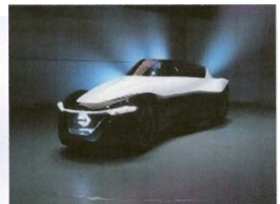
図41 日産 ブレイドグライダー 前席中央1人後席2人、左右後輪インホイールモータのEV、俯瞰すると三角翼に似た形状
