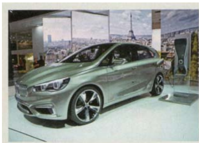
図1 BMW PHEV コンセプト EV 走行距離 30Km,燃費 40Km/L CO2 排出量 60g/Km
