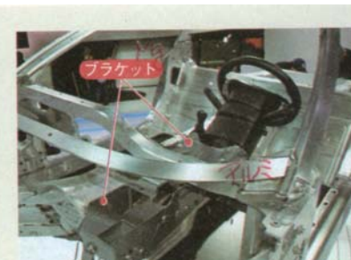
図8 GM Corvette Stingray 骨格 St'g Brkt は Mg, 骨格は Al(押し出し材)
