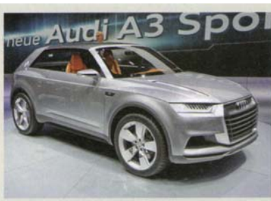
図2 Audi PHEV コンセプト EV 走行距離 86Km,燃費 91Km/L CO2 排出量 26g/Km
