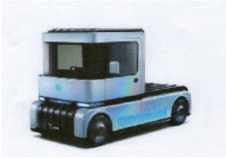
図 42 ダイハツ FC凸 DECK 燃料電池車 水素を使わないダイハツ独自開発、ボトルを交換する方式
