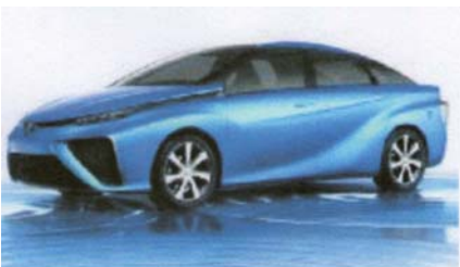
図39 トヨタ FCEV コンセプトカー スタックの出力小型にしても100KW以上、航続距離500Km/L
