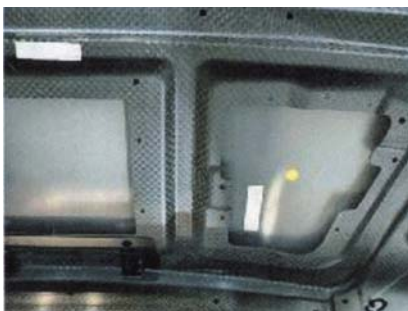
図 30 東レとダイムラー フッド内面 CFRP 化 メルセデスベンツ SL クラスに採用
